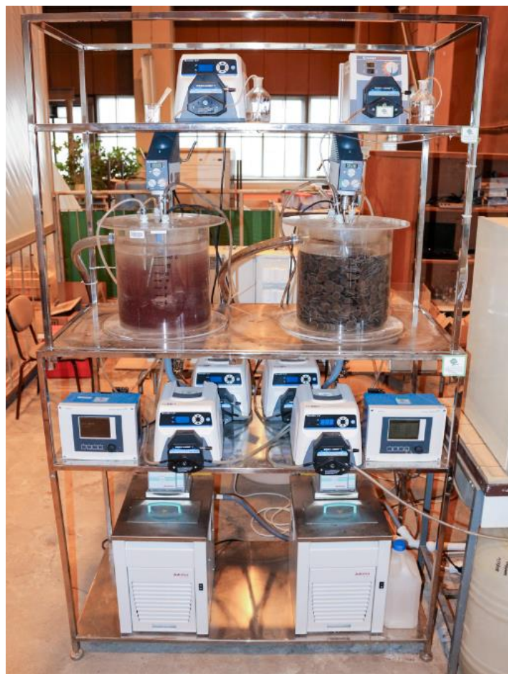
Rys. 3.2. Zestaw laboratoryjny z dwoma reaktorami SBR o pojemności 10 dm 3 : (a) schemat, (b) widok rzeczywisty
