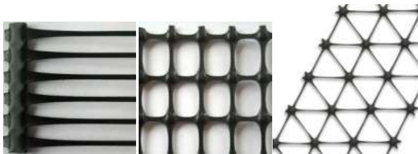
Rysunek 2.2 Geosiatki: a). jednokierunkowa, b). dwukierunkowa, c) heksagonalna
